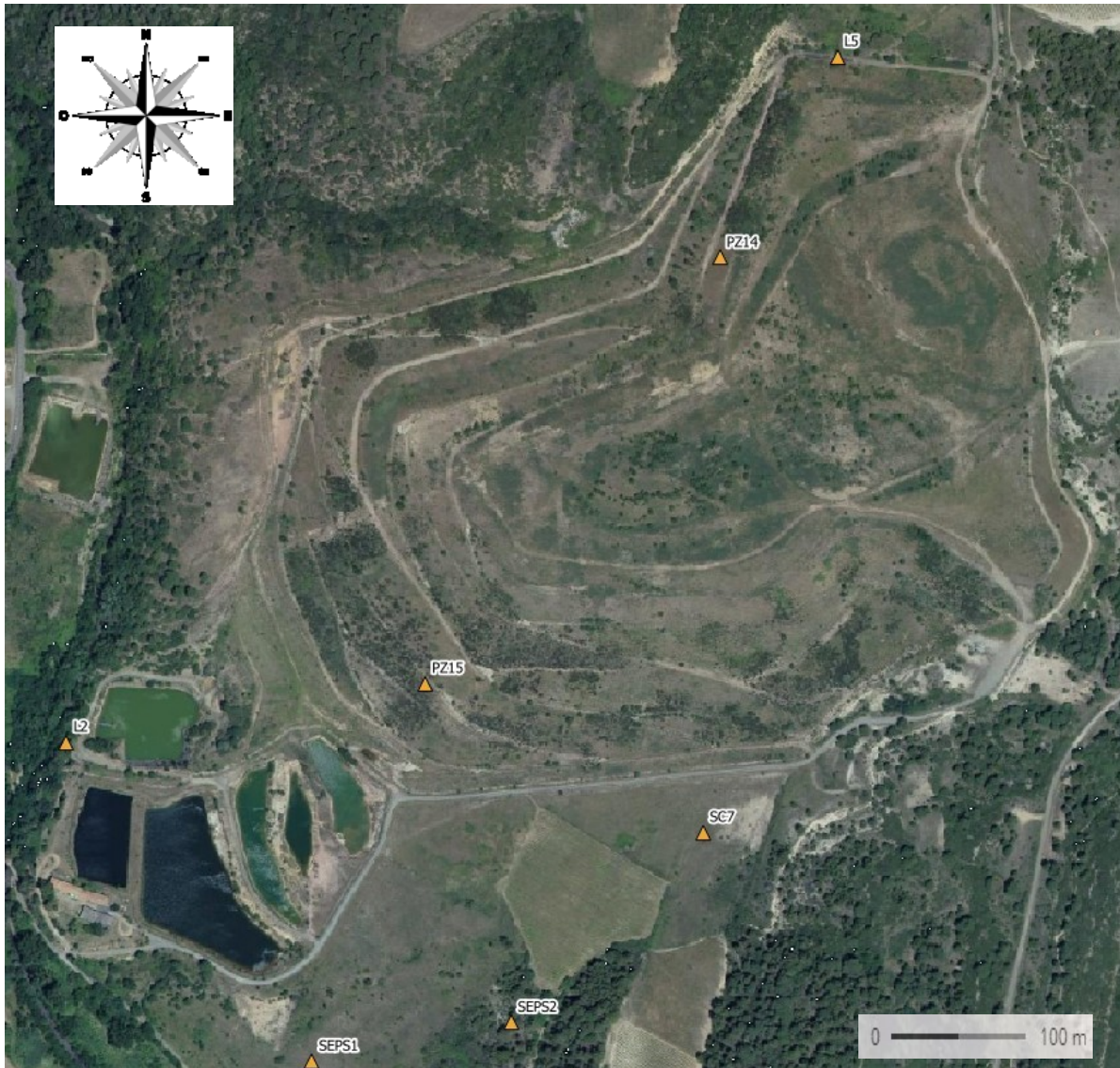
Figure 105 : Implantation des piézomètres à l'Artus
