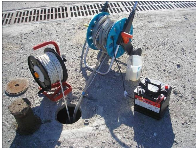
Photo 27 : Matériel de prélèvement des eaux souterraines
